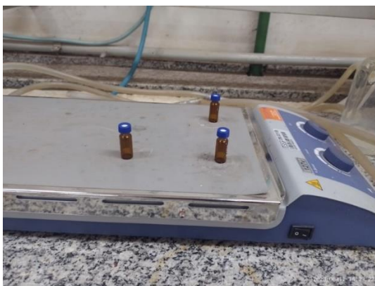
Figura 8. Fotografia do experimento de dissolução do padrão ICE-4 em limoneno, eugenol, farnezol e tolueno. Fonte: autoria própria.
